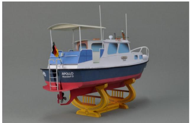
Bei einer Länge von 10,80 m und einer Breite von 3,20 m verdrängt der Stahlrumpf 10 Tonnen Wasser. Die Yacht verfügt über einen Schottel-Ruderpropeller, der von einem 6-Zylinder DAF Turbo-Diesel Motor mit 135 PS (100 kW) und einem Hubraum von 5,75 Liter angetrieben wird.
