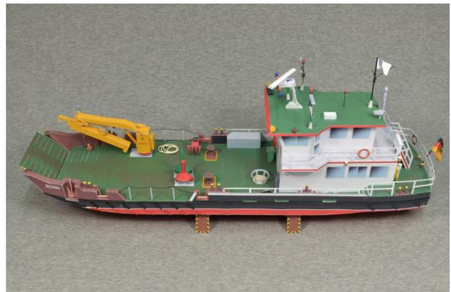
Um das 25,7 m lange und 6,6 m breite Schiff auch in beengten Verhältnissen sicher zu manövrieren, verfügt die Bonn über zwei Schottelantriebe mit je 91,5 kW (124 PS). Auf der
