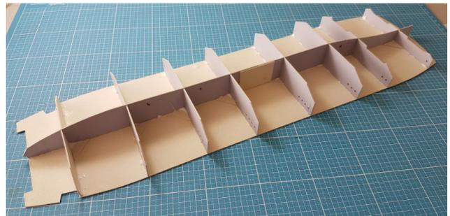
Verklebung an der Kante des Decks. Die Spanten müssen nicht verklebt werden.
